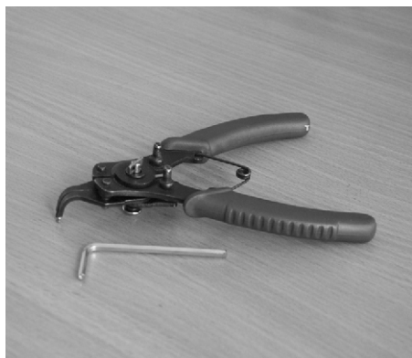
Zdjęcie 1 - potrzebne narzędzie: - szczypce do zakładania pierścieni osadczych sprężynujących - klucz do śrub z gniazdem sześciokątnym 3 mm
