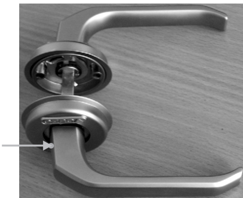
Zdjęcie 2 Odkręcić wkręt z gniazdem sześciokątnym i zdjąć klamkę z trzpienia.
